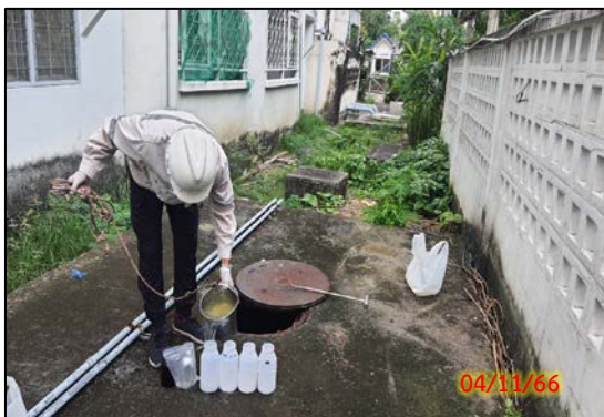
บ่อฟักก่อนเข้าระบบบำบัดน้ำเสียประจำอาคาร 3
